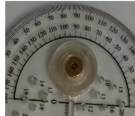
3. Le thamographe dispose de trous correspondant aux principales dimensions pour le rayon du cercle. Placer la pointe du crayon dans le trou qui convient et tourner. La partie fixe est maintenue par le doigt sur la feuille et le thamographe tourne autour.
