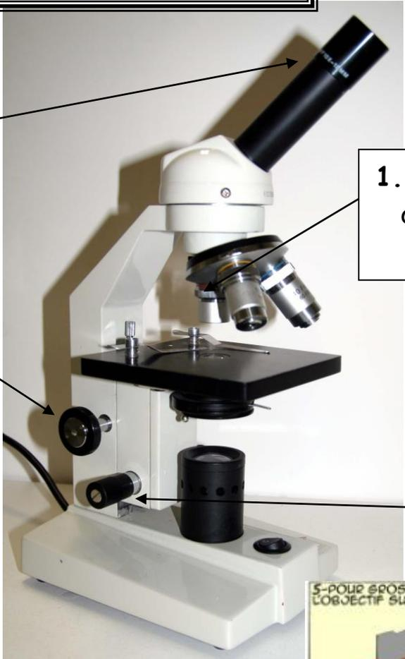
2. Regarde dans l'**oculaire** et fais la mise au point à l'aide de la **grosse vis** en la tournant tout **doucement** !
